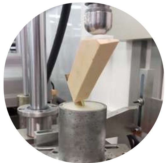
Ensaio biomecânico experimental com carregamento cíclico senoidal (fadiga) realizado na etapa de verificação do caso crítico (worst case) do projeto.
